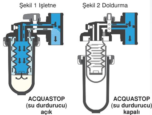
GEL dozlama ünitesinin dolumu çok kolaydır. Su durdurucunun kapatılması ve hava vanasının açılması ile Gelpur Rapid kartuşu kolaylıkla değiştirilebilir.
